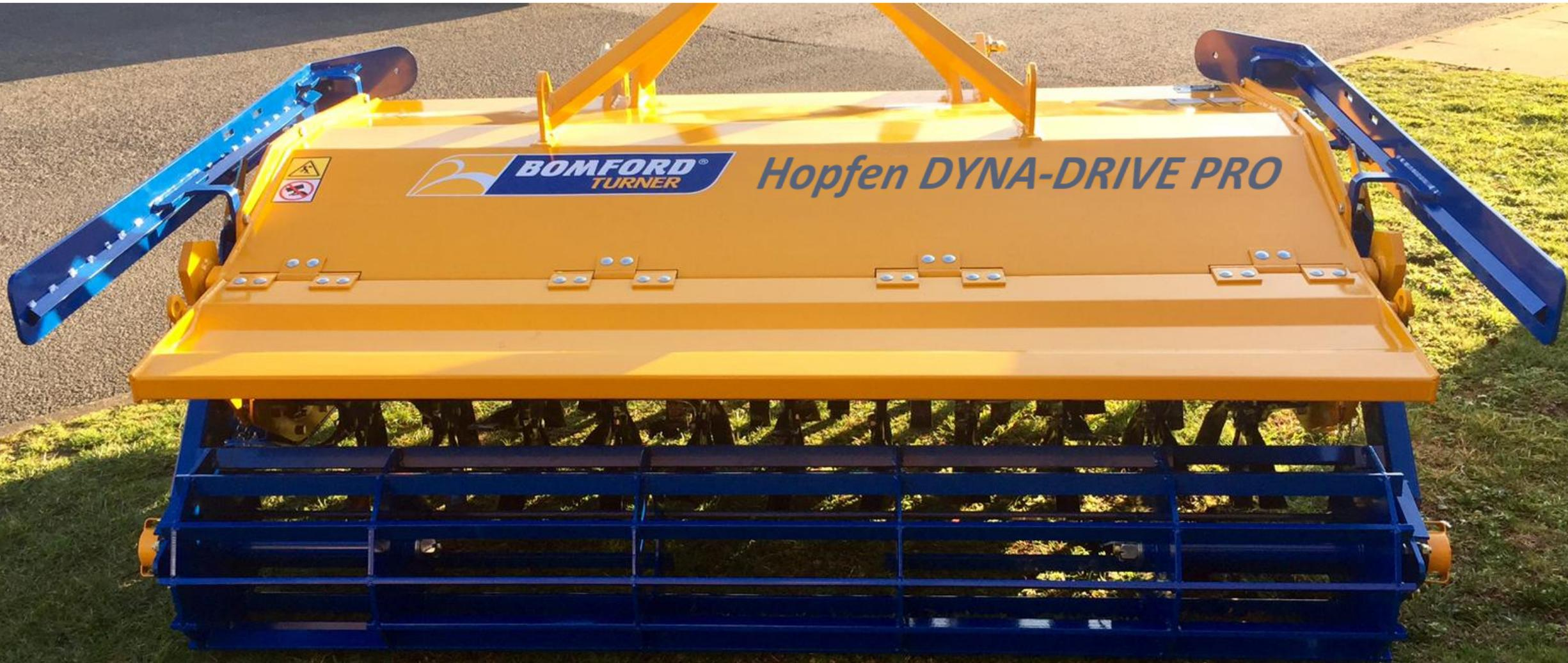
Auf dem hinteren Rotor wurde die Zinkenanzahl verdoppelt, um eine intensivere Bearbeitung zu erreichen
