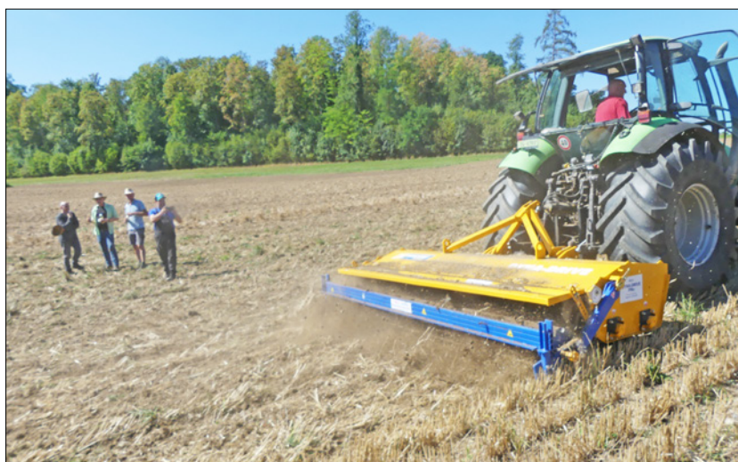
Seit einem Jahr kommt der Dynadrive auf dem Betrieb Isenring bei der Stoppelbearbeitung und dem Grünlandumbruch zum Einsatz.
