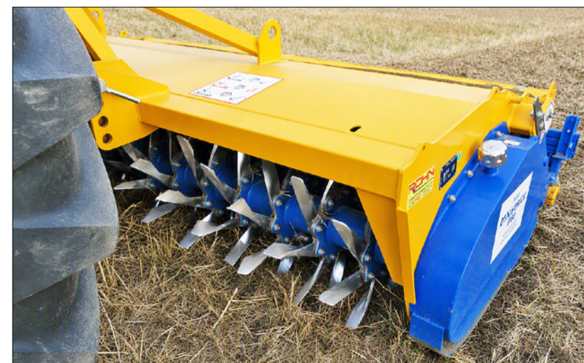
Die Löffelzinken graben sich in die Erde und durchmischen den Boden auf einer Arbeitstiefe von bis zu zehn Zentimetern.
